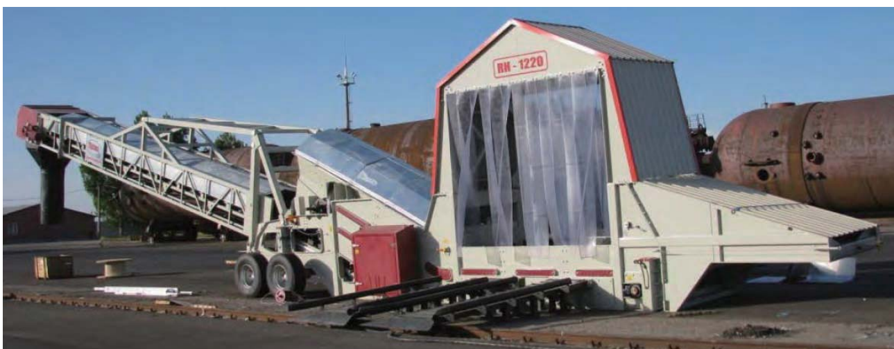
用途：2方向からのトラックアンローディング 装着オプション：密閉型ホッパー、カバー、密閉型シュート、スロープ
