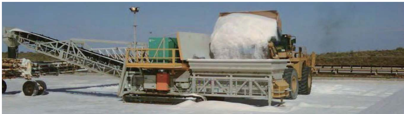
用途：払出し - ホイールローダにて投入、コンベヤへ定量供給 装備オプション：ヘッドシュート、ライト
