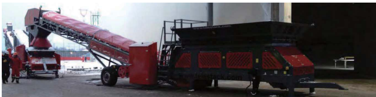
用途：払出し - テレスコピックコンベヤへ定量供給 装備オプション：防塵カバー、ヘッドシュート、 キャットウォーク
