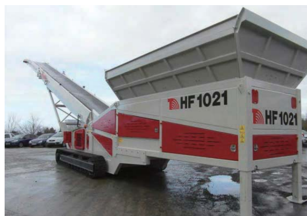
用途：払出し - テレスコピックコンベヤへ定量供給 装備オプション：防塵カバー、ヘッドシュート、 キャットウォーク
