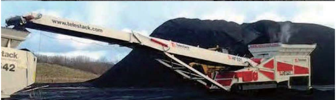
用途：払出し - ホイールローダにて投入、テレスコピックコンベヤへ定量供給
