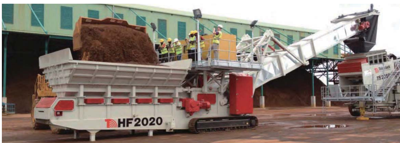
用途：払出し - ホイールローダにて投入、テレスコピックコンベヤへ定量供給 装備オプション：防塵カバー、ヘッドシュート、ライト、キャットウォーク
